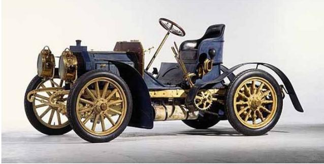
Abb. 11 Daimler Motorwagen Typ Mercedes Simplex 40 PS von 1902. Erstes niedrig gebautes Automobil [QB04]
