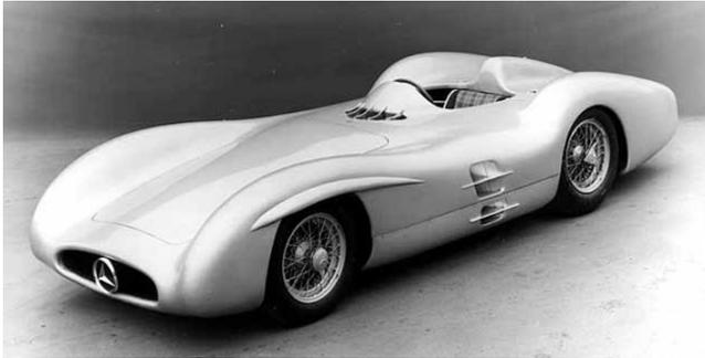
Abb. 47 Mercedes Benz Formel 1 Rennwagen 300 SLR W196 mit Stromlinienkarosserie von 1954 [QCD01]
