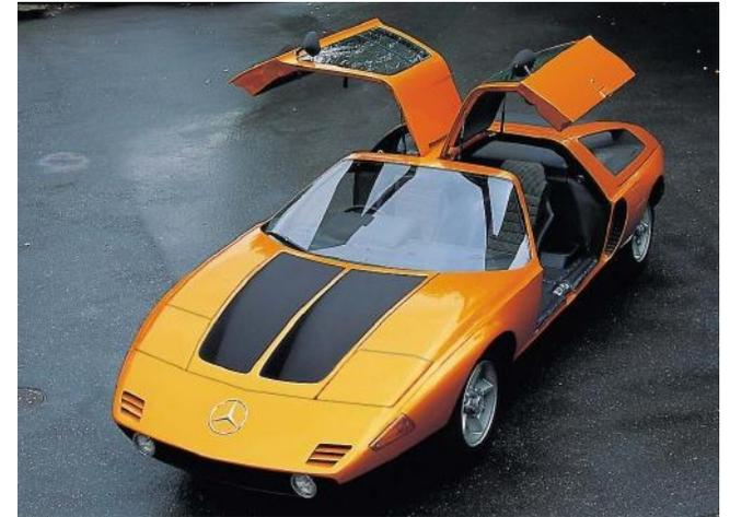
Abb. 64 Mercedes-Benz C 111-2, Forschungsfahrzeug mit Vierscheiben-Wankelmotor, 1970. [QW10]
