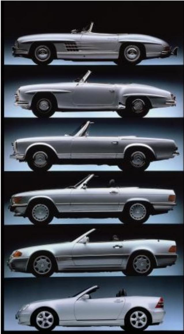
Abb. 86 SLK-Klasse, SL-Fahrzeuge, Historie der Roadster-Familie: Bild 1: 300 SL von 1954, (2) 190 SL von 1957, (3) 230 SL von 1963, (4) Modellreihe R 107 von 1971, (5) aktuelle Modellreihe R 129 (6) SLK neueste Version ab Modelljahr 2000. [QW10]
