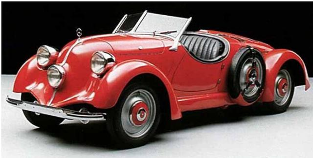
Abb. 29 Mercedes-Benz Typ 150 Sportroadster mit Mittelmotor von 1934 W30 [QCD01]
