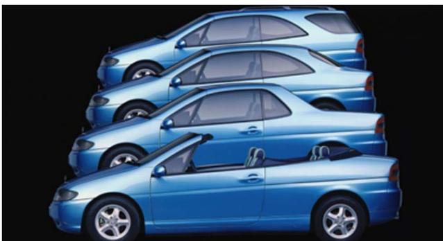
Abb. 70 Mercedes-Benz Vario Research Car - Ein Auto, vier Fahrzeuge, dies ist mit verschiedenen Aufbauten. Möglich. [QW06]
