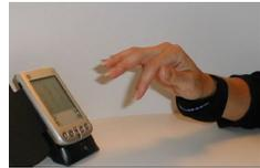
Abb. 30 LIGHTGLOVE in der Anwendung mit einem PDA [QW12]
