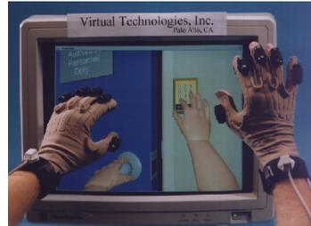
Abb. 4 VIRTUAL TECHNOLOGIES INC. CYBERTOUCH in der Anwendung [QW05]
