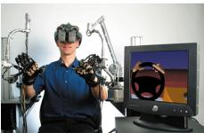
Abb. 64 zwei Hand CYBERFORCE System zum Testen von Virtuellen Prototypen [QW05]
