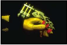
Abb. 15 Ein Prototy der DEXTEROUS HANDMASTER von EXOS. Ein Exoskeleton für einen Finger und Handrücken [QW01]
