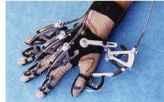
Abb. 51 V6 CYBERGRASP von IMMERSION mit Force Feedback [QW05]
