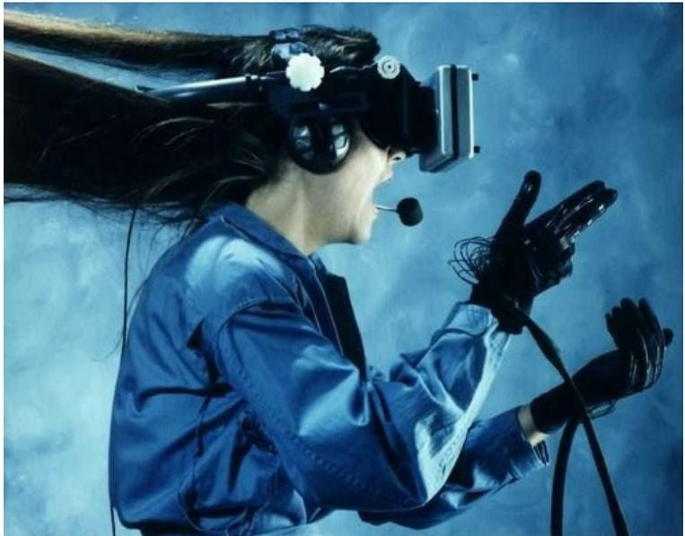
Abb. 12 Person mit Datenhandschuhen und Head Mounted Display. [QW33]
