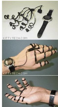
Abb. 59 KITTY arbeitet mit elektrischen Sensoren, die in flexiblen Kunststoffspiralen untergebracht sind. Jede Kombination aus zwei Sensoren, die man miteinander in Kontakt bringt, steht für ein anderes Eingabezeichen. [QZ02]
