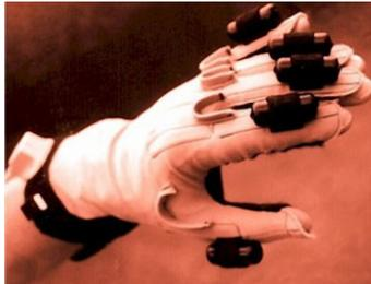
Abb. 3 IMMERSION CYBERTOUCH mit Vibrotaktilem Feedback [QW05]
