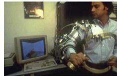
Abb. 52 Exoskeletton für einen Arm und eine Schulter [QW01]
