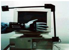
Abb. 22 Arkustisches Tracking-system des POWERGLOVE von MATTEL und NINTENDO [QW211]
