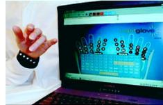
Abb. 29 LIGHTGLOVE mit virtueller Keyboard Software [QZ02]
