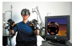
Abb. 53 Force Feedback - System CYBERFORCE für virtuelle Prototypen mit der HAPTIC WORKSTATION von IMMERSION [QW05]
