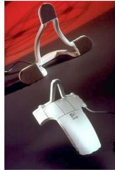
Abb. 05 LOGITECH 3D-MAUS von 1992 mit Ultraschall Sender und Empfänger [QW13]
