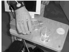
Abb. 66 Ein Bewegungsablauf wird mit einem Datenhandschuh vorgemacht. Die Bewegungsdaten werden an den Roboter weitergegeben [QW26]
