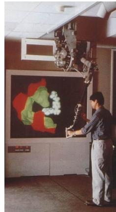
Abb. 14 University of North Carolina, HAPTIC DISPLAY GROPE III [QB02] Mit diesem Haptic Device ist der erste und einzige Unfall passiert. Der Arm eines Benutzers wurde aufgrund einer Fehlfunktion gebrochen. [QP01]
