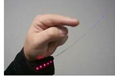
Abb. 28 IR bzw. Laser Sensoren des LIGHTGLOVE [QW12]
