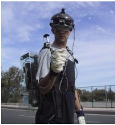
Abb. 71 Mobiles Computersystem im Freien mit Datenhandschuh basiertem Interface [QW23]
