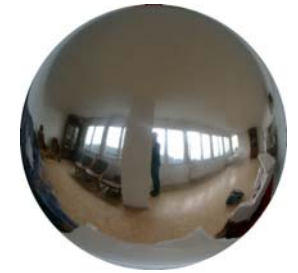
HDRI Foto einer Chromkugel anhand derer sich die Lichtstimmung einer Umgebung einfangen lässt
